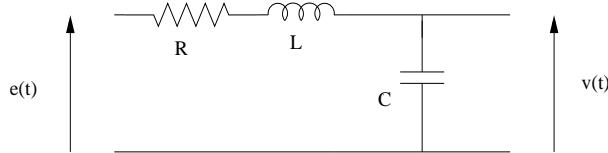
On considère un circuit RLC possédant une tension d'entrée  $e(t)$  et une tension de sortie  $v(t)$ .
