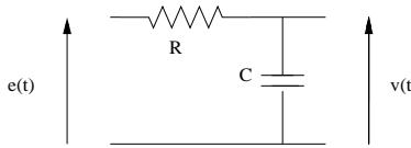
On considère une cellule RC possédant une tension d'entrée  $e(t)$  et une tension de sortie  $v(t)$ .
