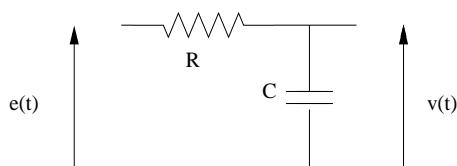
1°. Montrer que le circuit est piloté par l'équation  $\begin{cases} RCv'(t) + v(t) = u(t) \\ v(t) = 0 \text{ si } t \leq 0 \end{cases}$
