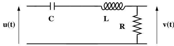
1°. Montrer que la fonction de transfert du filtre est  $T(i\omega) = \frac{2mi\omega/\omega_0}{1 + 2mi\omega/\omega_0 - (\omega/\omega_0)^2}$
