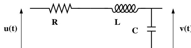
On pose  $\omega_0 = \frac{1}{\sqrt{LC}}$  qui est la pulsation propre du circuit et  $m = \frac{RC\omega_0}{2} = \frac{R}{2}\sqrt{\frac{C}{L}}$  qui s'appelle le facteur d'amortissement.
